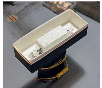
Damit die Innenbeleuchtung schön schummrig wurde, mussten die Lichtsockel der LED verkleidet werden. Das Licht verteilt sich so indirekt über die Dachinnenseite im ganzen Raum.
