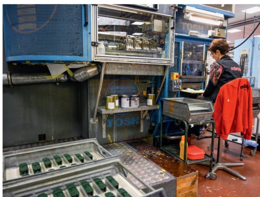
An der Tampondruckmaschine wird gerade das H0-Modell des ...
