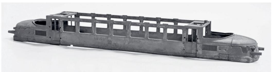
Das Gehäuse des roten Pfeils hat das Phosphatbad in der Galvanik bereits hinter sich und kommt nun zur Farbgebung in die Lackiererei.
