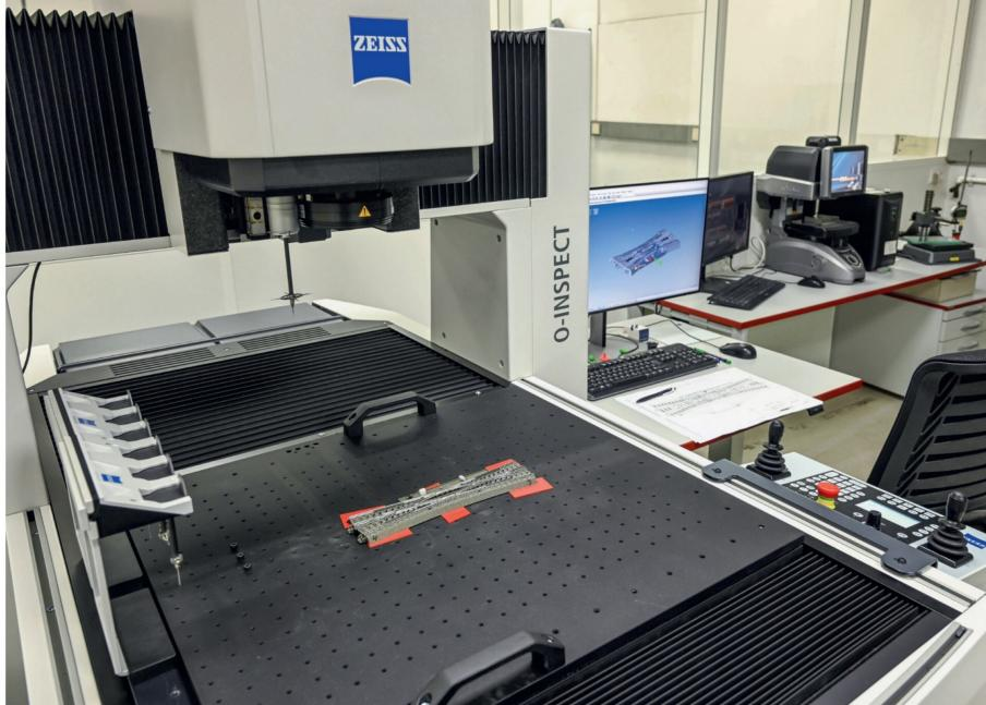
Mit dem Multisensorsmessgerät können Produkte bis auf einen Tausendstelmillimeter genau kontrolliert werden. Anhand der Messung erzeugt das Gerät eine 3-D-Darstellung auf dem Monitor.
