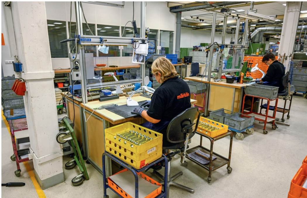
In der Gussnachbearbeitung sorgen mehrere erfahrene Mitarbeiterinnen dafür, dass die Rohlinge entgratet und geschliffen werden.
