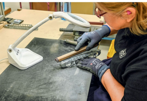
Mit viel Fingerspitzengefühl werden vorstehende Teile abgeschliffen.
