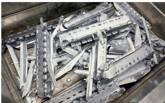
Noch handwarm ist das Gussteil, wenn es zur Kontrolle dem Fliessband entnommen wird.
