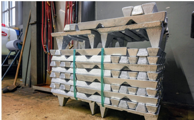
Aus diesen Zinkbarren entstehen im Göppinger Stammwerk die bekannten Märklin-Modelle.
