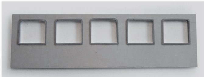
Ausgesägte Fenster mit einzeln ausgeschnittenen und aufgeklebten Fensterrahmen aus Karton.
