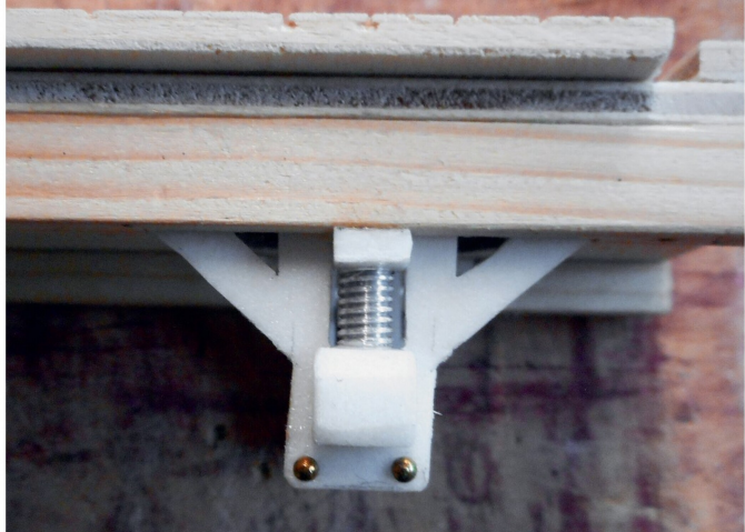
Lagerblende mit Gewindestangenstück als Feder, Blende und Achslagerimitation aus Kunststoff.
