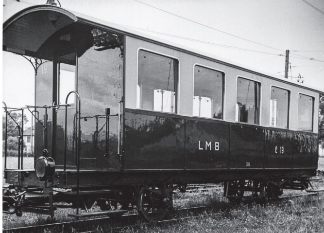
1943: der C 19 mit einem grün-gelben Anstrich. Bei der Revision wurden die Dachlüfter entfernt.
