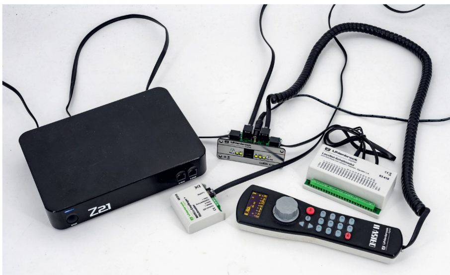
Zentralen mit LocoNet-Bus, wie hier Rocos schwarze Z21, können nun auch massegebundene LocoNet-Module einbinden.
