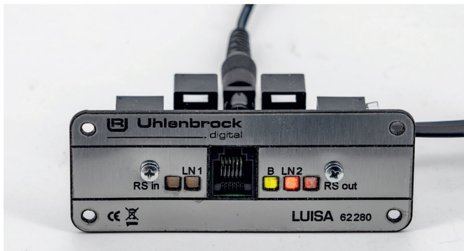
An den LED sieht man sofort, dass am Eingang noch nichts angeschlossen ist.
