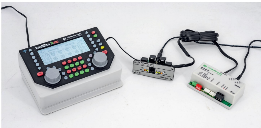
Zentralen mit LocoNet-B-Anschluss, wie hier Uhlenbrocks Intellibox 2neo, können auch Booster direkt via LocoNet-B bedienen und auslesen.
