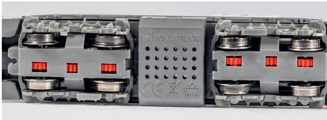
Das Modell von unten: Alle vier Achsen sind angetrieben, zwei Räder weisen Haftreifen auf.
