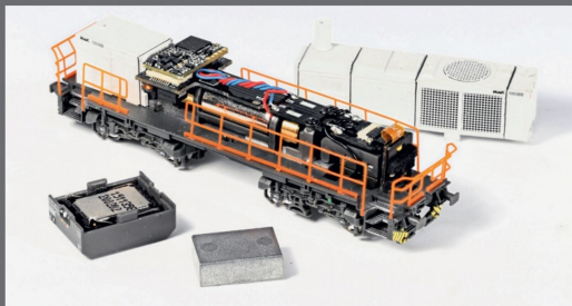
Teildemontage des N-Modells für die Digitalisierung mit Sound.
