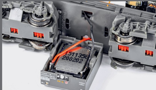
Bevor der Tank eingeklipst wird, Kabel durch den Rahmen führen.
