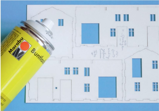
Fensterweiss überdeckt den minimalen Laserruss an den Schnittkanten.
