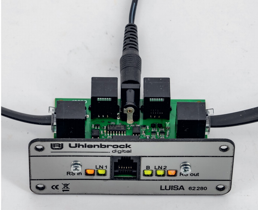
Die orangefarbenen LED signalisieren, dass ein LocoNet-B-Signal am Ein- und Ausgang vorhanden ist.
