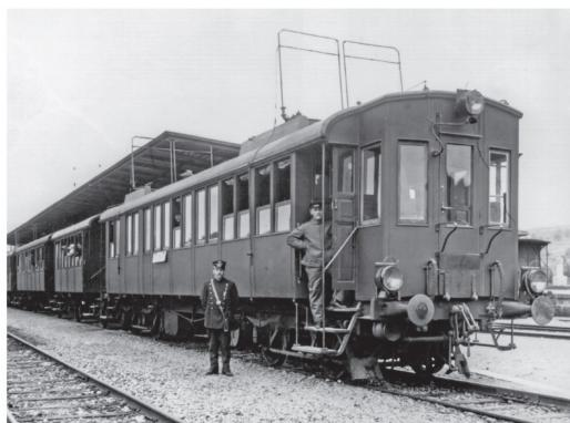
Das Besondere an den BCe 4/4-Triebwagen: Die «Automobilwagen» hatten zu Beginn keine Einstiegstüren. Speziell für den Winter wurden später Türen montiert, die im Sommer jedoch wieder entfernt wurden.
