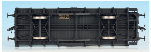
Der L2 des Gaswerks Schlieren verfügte lediglich über eine Handbremse.
