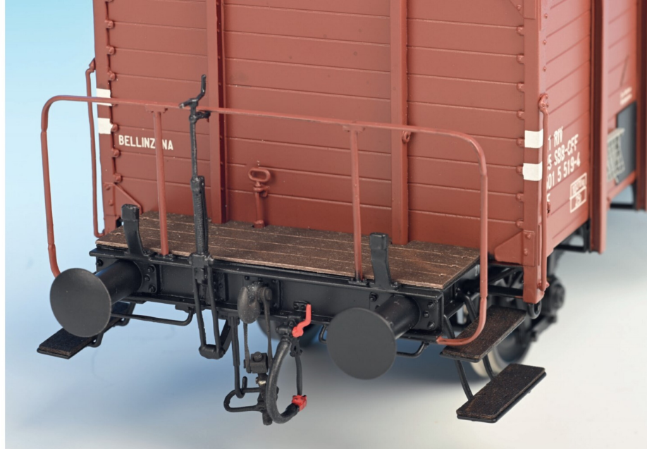
Die Plattformen, Trittbretter und Innenböden sind mit gelasertem Holz belegt.
