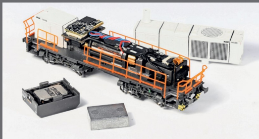
Teildemontage des N-Modells für die Digitalisierung mit Sound.
