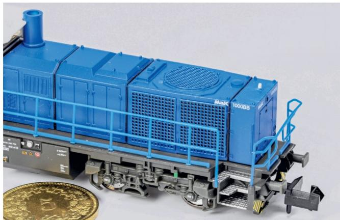
Die Handläufe des Umlaufs sind aus elastischem Kunststoff gefertigt und aufgesteckt.
