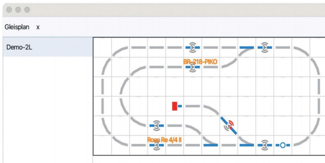
Das Gleisbildstellwerk der CTC-App mit Positionsmeldung der Lokomotiven in den Blöcken.
