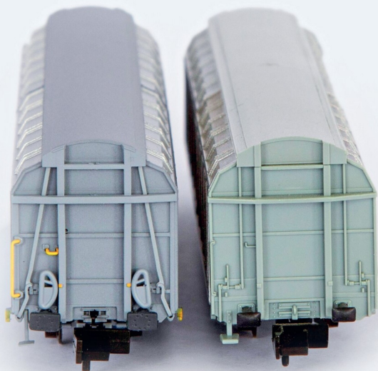
Das Trix-Modell weist vorbildwidrig die Verriegelungsmechanik nach deutscher Bauart auf.
