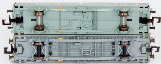
Deutlich detaillierter als die Trix-Umsetzung präsentiert sich der Unterboden des Wagens.
