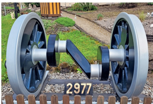
Dieser Treibradsatz stammt von der SBB-Dampflokomotive C 5/6 2977.
