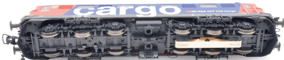
Das Fahrwerk der Ae 610 cargo mit dem AC/DC-Schalter und dem montierten Schleifer, der sich mit einem Handgriff entfernen lässt.
