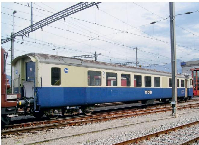
Die für den Autozugverkehr umgebauten Steuerwagen erhielten am Wagenende eine grosse Schiebetür mit Vordach. Die ursprünglichen Rangiergriffe und -ritte wurden dabei belassen.
