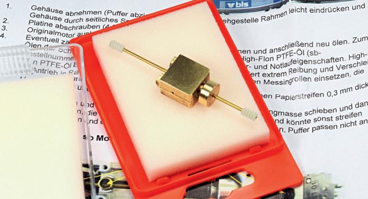
problematisch. Um hier eine grundlegende und wirksame Abhilfe zu schaffen, bietet sich die Verwendung von sogenannten Glockenankermotoren an. Diese werden von der Modellbahnindustrie auch teilweise eingebaut, flächendeckend haben sie sich aber noch nicht durchgesetzt, was sicherlich auch kalkulatorische Gründe hat. Ein weiterer Grund für die Umrüstung auf einen Glockenankermotor ist, wenn der Motor eines alten Schätzchens defekt und ein Ersatzteil nicht mehr verfügbar ist.
