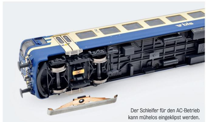
Der Schleifer für den AC-Betrieb kann mühelos eingeklipst werden.
