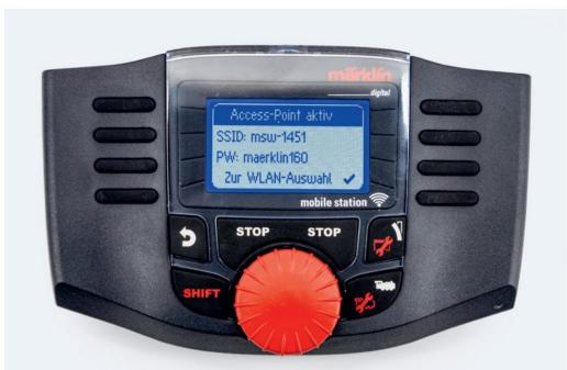
Nach dem Einschalten spannt die MSW ein eigenes WLAN-Netz auf.
