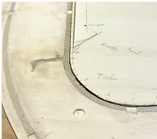
Vor der Farbgebung wurde noch einmal die Passgenauigkeit des Strassenelementes zu jenem mit dem Randstein geprüft.
