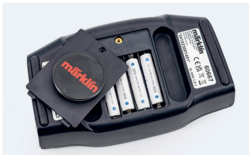
Zum Wechseln der Batterien muss man die Rückwand abschrauben.
