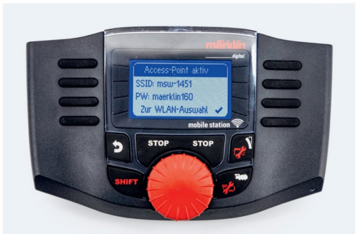
Nach dem Einschalten spannt die MSW ein eigenes WLAN-Netz auf.
