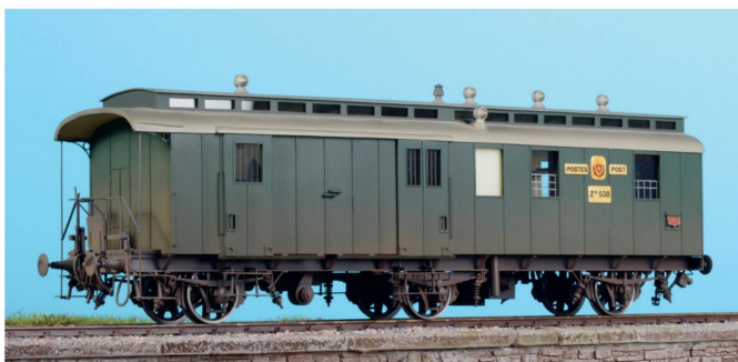
Der Wagen Z 538 wurde mit Material aus Polystyrol aufgebaut. (Erbauer: Ernst Schuppli †)
