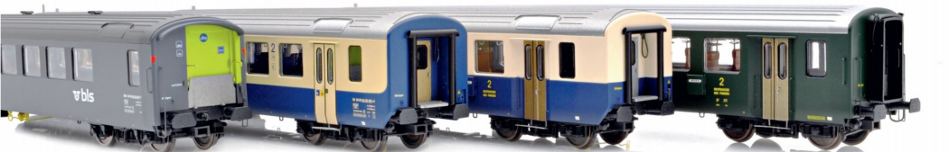
Das zugsseitige Wagenende in den unterschiedlichen Ausführungen für Autozüge, mit Gummiwulst und Faltenbalgübergang.
