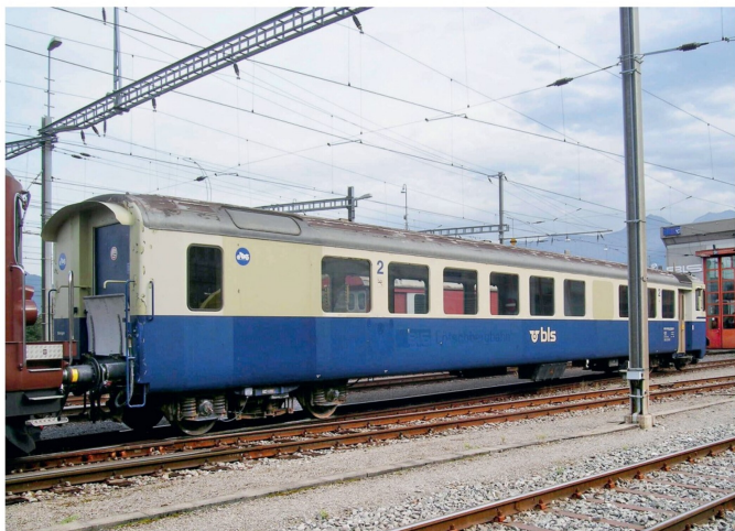
Die für den Autozugsverkehr umgebauten Steuerwagen erhielten am Wagenende eine grosse Schiebetür mit Vordach. Die ursprünglichen Rangiergriffe und -tritte wurden dabei belassen.
