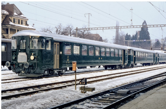
1963 erfolgte die Anlieferung der drei noch nicht komplett fertiggestellten Steuerwagen BN Bt 215, GBS Bt 214 und BN Bt 216 aus Schlieren. Noch weisen die Wagen runde Pufferteller auf.
