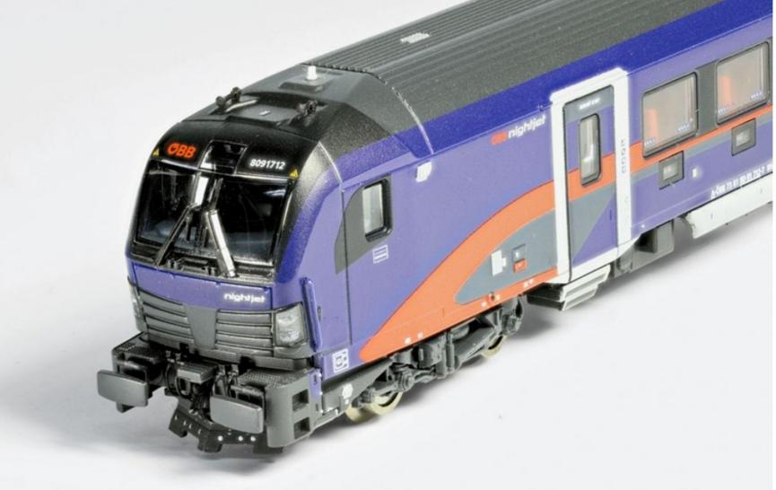
Elektrisch leitende Magnetkupplungen mit mechanischer Sicherung sind bei Fleischmann erstmals im Einsatz.
