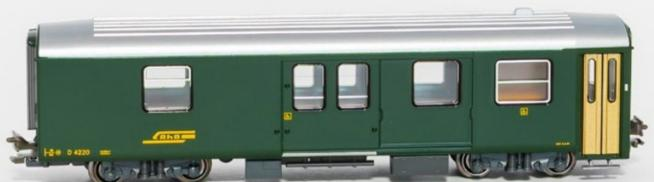
Passend für die Epoche wurden beim Gepäckwagen Dach und Fensterteilung angepasst.
