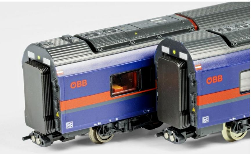
staltete Innenleben frei. Der Steuerwagen mit seinem charakteristischen Vectron-Gesicht ist gut getroffen. Der Führerstand ist nachgebildet und durch die mächtigen Scheiben gut sichtbar. Der Pufferbohlenbereich ist, so gut es der N-Massstab lässt, vollständig nachgebildet. Zughaken und Bremsschläuche sind bereits werkseitig montiert, was die Nerven und damit auch das Seelenheil des Modellbahners schont.
