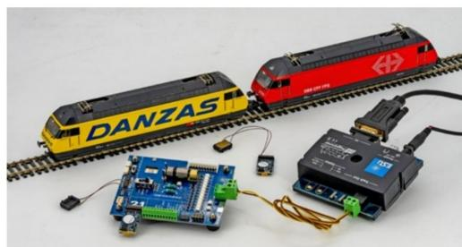
ESU-LokProgrammer und -Testboard fürs Programmieren der ESU ...
