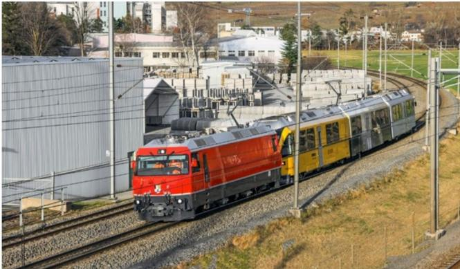
Am 8. Dezember 2025 gab es erstmals Lastprobefahrten mit der RhB Ge 4/4 II 653 im Raum Untervaz/Trimmis. Für die Simulation der Anhängelast diente der Ahnennzug (ABe 8/12 3514).
