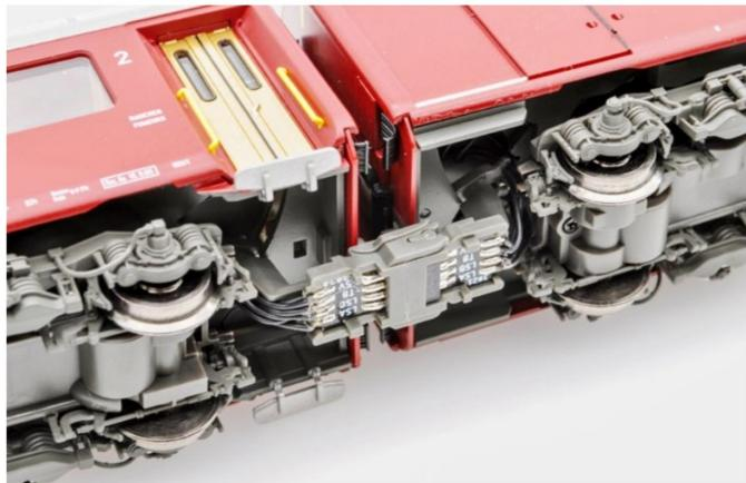
Blick auf die untenherum freiliegende elektrische Kupplung des neuen H0-Modells von PIKO.
