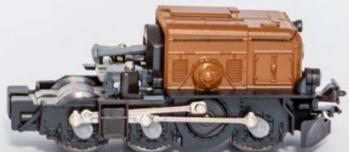
Der Mittelteil mit dem Motorblock und die beiden Vorbauten des Krokodils lassen sich mit einigen wenigen einfachen Handgriffen trennen.
