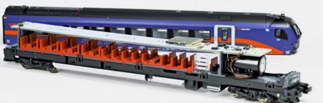
Das Innenleben des Steuerwagens mit Elektronik und mehrteiliger, farbiger Inneneinrichtung.
