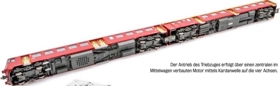
Der Antrieb des Triebzuges erfolgt über einen zentralen im Mittelwagen verbauten Motor mittels Kardanwelle auf die vier Achsen.
