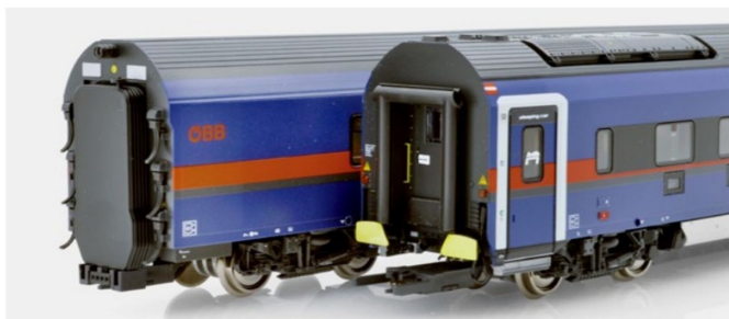
Unterschiedliche Übergänge beim normalen Wagen (links) und beim Schlusswagen (rechts).
