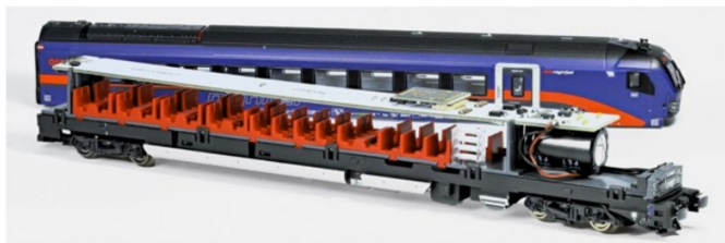
Das Innenleben des Steuerwagens mit Elektronik und mehrteiliger, farbiger Inneneinrichtung.
