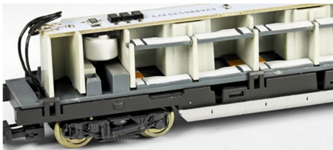
Der Schlafwagen von innen mit gut bestückter Beleuchtungsplatine und Kondensator.
