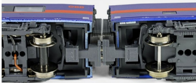
Leitende Magnetkupplungen sorgen für sicheren Halt und die Beleuchtungsstromübertragung.
