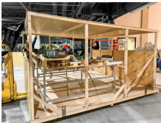
Die einzelnen Anlagenteile wurden auf Holzböden gesetzt, für den Transport mit einem Holzaufbau versehen und in Kunststoffolie eingepackt.
