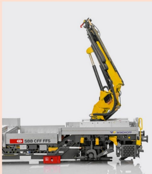
Besonderen Wert legte der Erbauer auf den Kran des Bahndienstfahrzeuges. Dieser kann händisch in verschiedene Positionen gebracht werden.
