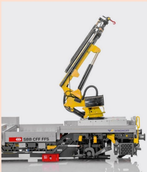
Besonderen Wert legte der Erbauer auf den Kran des Bahndienstfahrzeuges. Dieser kann händisch in verschiedene Positionen gebracht werden.
