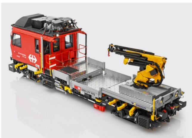
Der Kran auf der Ladefläche des Tm 234.4 DART ist beweglich ausgeführt.
