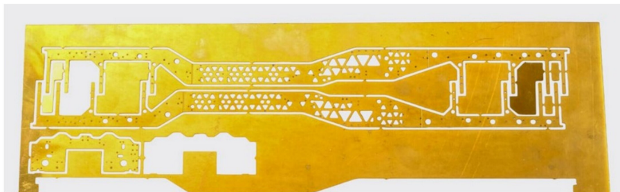
model rail in Nendeln setzte die Zeichnungen von Robert Schmid in CAD-Pläne um und hat die Seiten- und Frontbleche geätzt.
