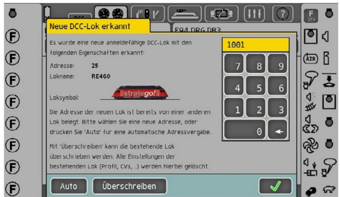
Die automatische RailComPlus-Anmeldeprozedur wird am Display der ESU ECoS angezeigt.
