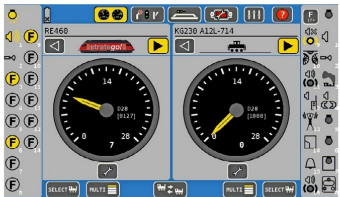
Die Fahrregleranzeige auf der ECoS von ESU wird zur Steuerung der Verbundadresse genutzt.
