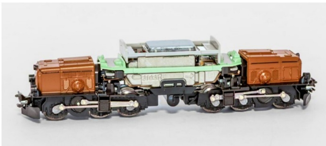
Anstelle des zukünftigen Decoders verfügt die analoge Variante über ein Zusatzgewicht.
