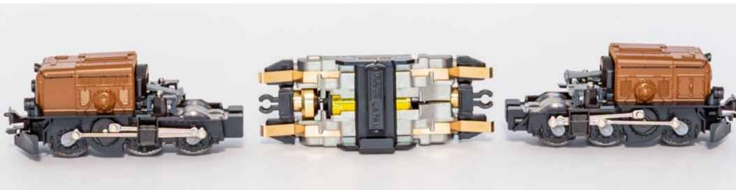
Der Mittelteil mit dem Motorblock und die beiden Vorbauten des Krokodils lassen sich mit einigen wenigen einfachen Handgriffen trennen.
