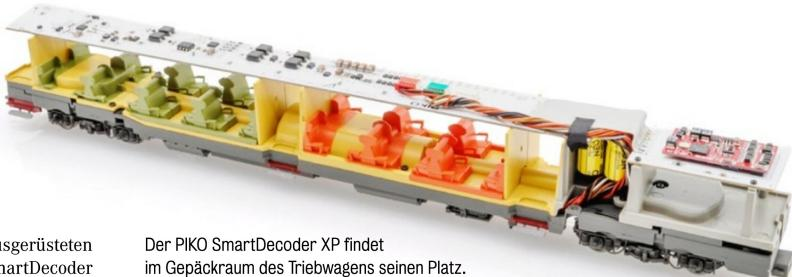
Bei den ab Werk mit Sound ausgerüsteten Varianten kommt ein PIKO SmartDecoder XP Sound zum Einsatz. Der Decoder unterstützt alle auf dem Markt gängigen Datenformate. Die Soundwiedergabe erfolgt über einen am Wagenboden der beiden Endwagen angebrachten Lautsprecher.
