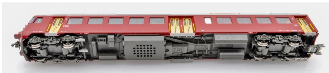
Die Wiedergabe der Fahr- und Betriebsgeräusche sowie der Ansagen erfolgt jeweils über einen in den beiden Endwagen verbauten Lautsprecher.
