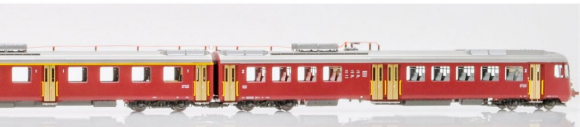
Die Wiedergabe der Fahr- und Betriebsgeräusche sowie der Ansagen erfolgt jeweils über einen in den beiden Endwagen verbauten Lautsprecher.
