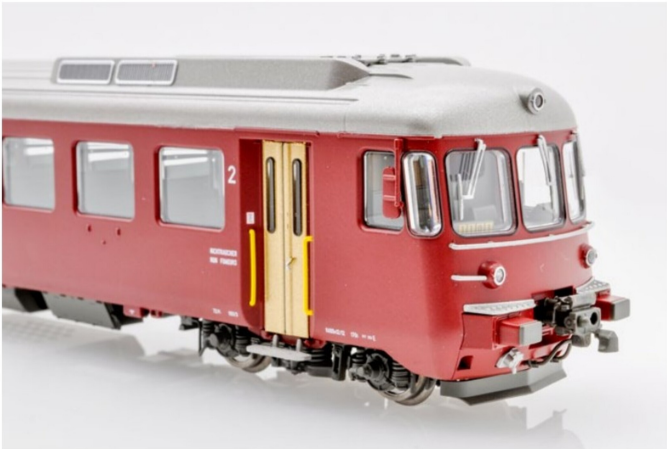
Die GF-Kupplung kann für Mehrfachtraktionen gegen eine elektrische ausgetauscht werden.
