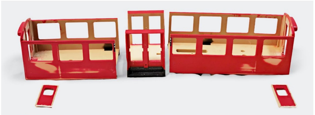
Die Wagen wurden auf der Kreissäge zersägt, eine genaue Schnittkante ist für den späteren Zusammenbau zwingend nötig.
