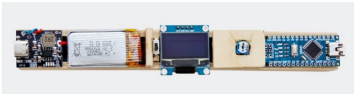
Das Gehäuse mit der Aussparung für das Display ist mittels 3D-Druck-Technologie entstanden.
