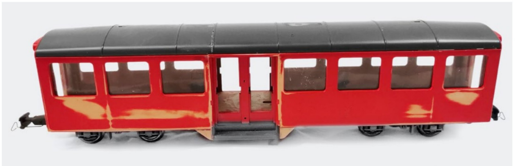
Die einzelnen Teile des Wagenkastens sind verklebt. Somit ist der Wagen bereit für sein neues BVZ Farbleid. Davor folgt aber eine Grundierung.
