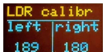
Das Display zeigt die Messschwelle der Lichtsensoren bei der Kalibrierung der LDR-Werte.
