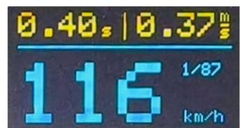
Das Display zeigt die Messgeschwindigkeit, nachdem eine Lok den Messwagen passiert hat.
