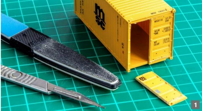
**Bild 2:** Nach einer Stunde waren die beiden Türen entfernt. Der Boden des Containers war einfach eingesteckt und liess sich daher leicht entfernen. Die Kanten wurden abschliessend mit einem Stück feinem Sandpapier verschliffen.
