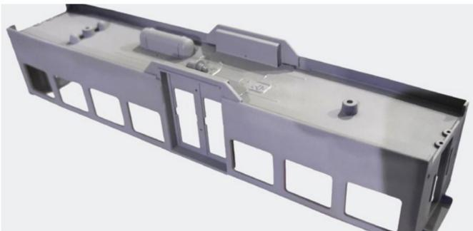
Nach dem Auftragen der Grundierung werden auffällige Stellen zum Nacharbeiten ersichtlich.
