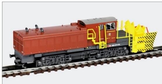
Der Maschinenteil des Modells ist wie beim Vorbild um 180 Grad drehbar ausgeführt. Die Funktion F4 löst den Drehvorgang aus. Ein Video davon ist auf unserer Webseite zu finden.
