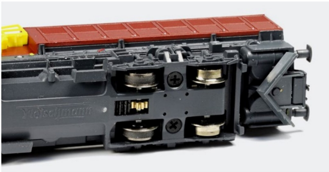
Nur eine Achse ist angetrieben, dafür aber beidseitig mit Gummihafterreifen belegt.
