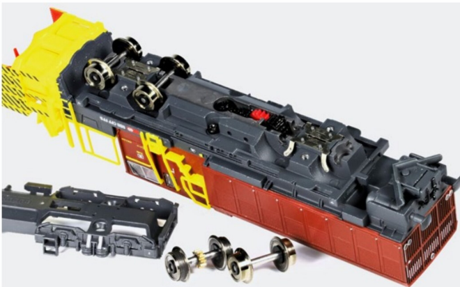
Die abgenommene Abdeckung gibt den Blick auf Getriebe und Stromaufnahme frei.
