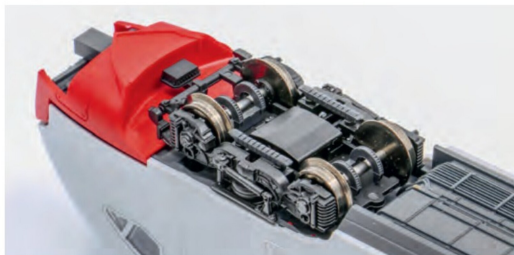
Zu sehen am Drehgestell: Bremscheiben und Träger der Zugsicherung.
