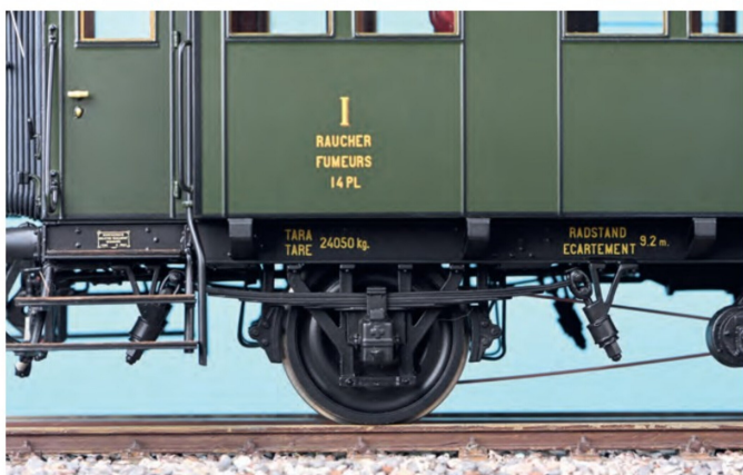
Die Federpakete sind vorbildrichtig je nach Wagenklasse unterschiedlich lang ausgeführt.
