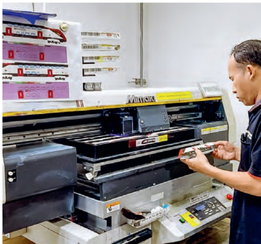
Mittels UV-Digitaldruck werden ausgewählte Beschriftungen aufgebracht.
