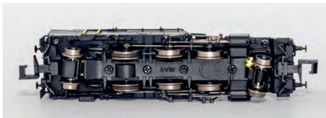
Der Kraftübertragung erfolgt von einem im Kessel verbauten Motor auf eine Antriebsachse ...
