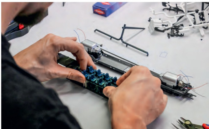
Während der Vorserienmontage wird hier die Inneneinrichtung in einen Motorwagen eingebaut.
