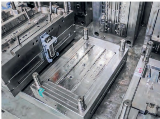
Die Spritzgussform für die Fenster eines Mittelwagens ...
