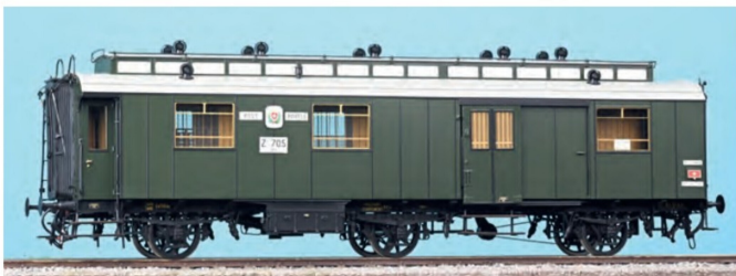
Der Z3ü 705 mit geschlossenen Übergängen, internem Seitengang und Postschild aus Emaille.
