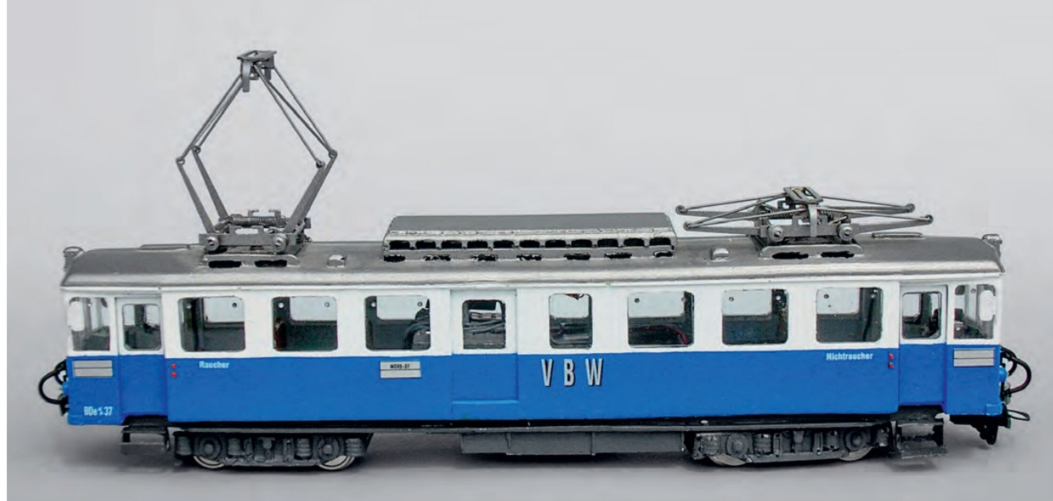
Der BDe 4/4 37 aus dem Jahre 1913 als Modell in Spur H0m von Lars Uenver im Zustand nach der Modernisierung von 1958.
