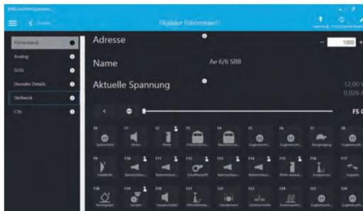
Mit dem SmartProgrammer und der zugehörigen App sind Testfahrten möglich. Beim digitalen Führerstand in der SmartProgrammer-App werden die Funktionssymbole und Bezeichnungen per RailCom eingelesen.
