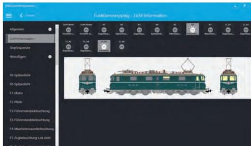
Praktisch ist die Möglichkeit der Lichtinformationen. Hier kann man per Button in einer Simulation ausprobieren, welche Lichter angehen.
