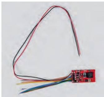
Der SmartDecoder XP F ist ziemlich frisch im PIKO-Programm und ein vollwertiger Multiprotokolldecoder mit DCC, RailComPlus, Motorola und mfx. Die acht verstärkten und zusätzlich zwei logische Funktionsausgänge können auf alle Funktionen bis F68 gemappt werden.
