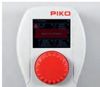
Per RailComPlus angemeldete Triebfahrzeuge werden der Datenbank des Digitalsystems automatisch hinzugefügt und stehen sofort zur Steuerung bereit. Das ist auch bei der aktuellen Decodergeneration XP so. Hier ist eine neue Lok vom PIKO-Digitalsystem SmartControl WLAN gefunden worden. Eine Meldung im Display des Handreglers informiert über die neue Lok.
