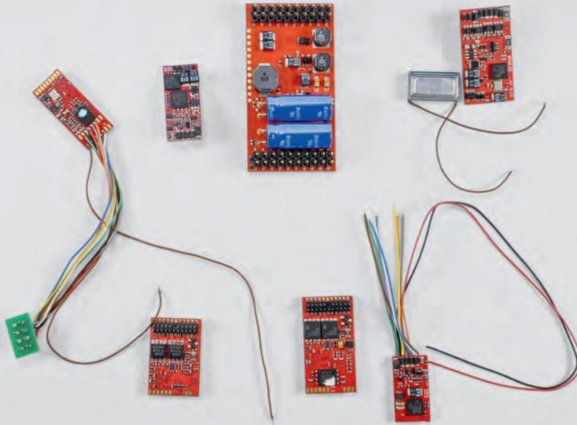
PIKO bietet mit den XP- und XP-S-Decodern ein breites Spektrum für die Baugrößen N, TT, H0 und IIm mit verschiedenen Schnittstellen.
