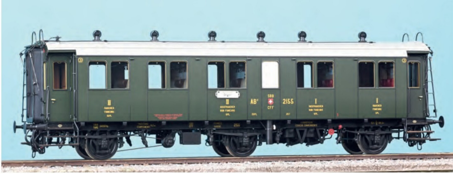
Der AB3ü 2155 verfügt über eine Vakuumbremse für den Einsatz in Österreich.
